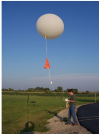
Radiosonda a punto de ser lanzada. Foto de Darrin Hansing, NWS
